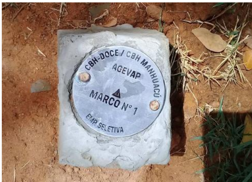
Figura 11 - Exemplo de marco topográfico
